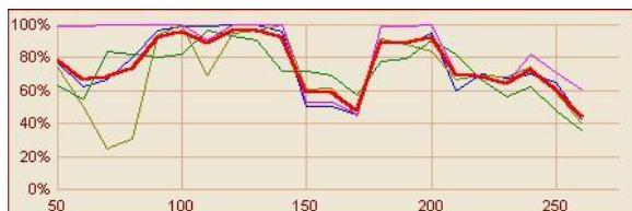
Окно активизируется при нажатии кнопки . Графики различных цветов показывают изменения текущих показателей физического состояния в процессе записи. По оси абсцисс откладываются номера RR-интервалов. Первые значения появляются на графиках через 60 отсчетов после включения записи и далее достраиваются через каждые 10 отсчетов.
