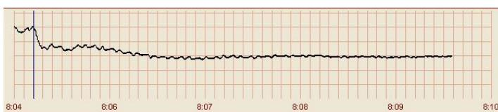
Отсутствует контакт между электродами и дистанционным модулем. Проверить кабель отведений.
