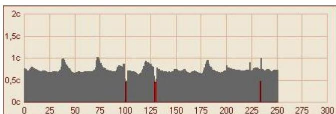
Отображает зависимость длительности RR-интервала от номера цикла измерения. Красным цветом на ритмограмме отмечаются артефакты. По оси абсцисс откладывается номер RR-интервала, по оси ординат время в секундах. Ритмограмма может отображаться в двух режимах: 300 и 100 отсчетов. Для переключения режимов используется кнопка «100/300».
