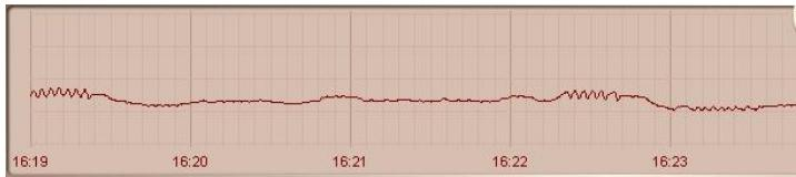
Отсутствует контакт между электродами и дистанционным модулем – проверить кабель отведений и крепление электродов
