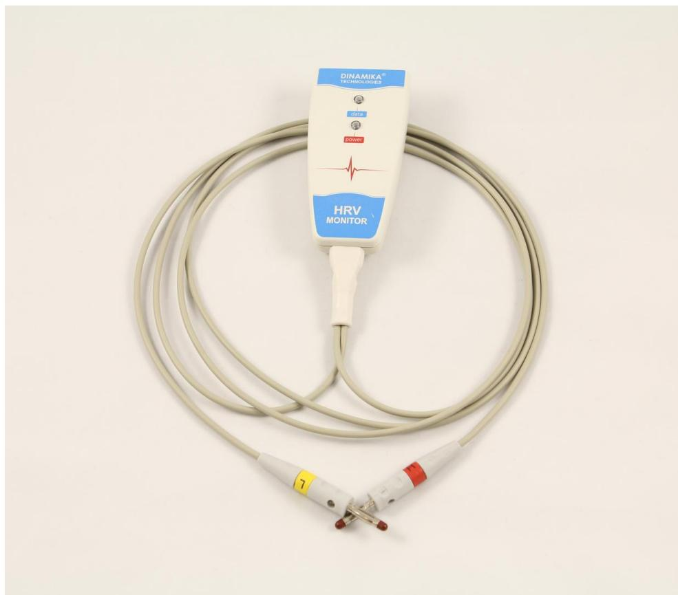
Если кабель электродов исправен, то при соединении обоих электродов друг с другом сигнал ЭКГ на экране должен быстро принять вид идеальной прямой. В первые секунды эта прямая будет колебаться от верхней до нижней части графика, но очень быстро она должна расположиться точно по центру графика ЭКГ и в дальнейшем не менять свой вид до размыкания вами электродов.
