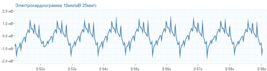
Если вы используете для работы с Приложением ноутбук, то самым простым способом подавления помехи будет отсоединение от него кабеля электропитания на время работы с Приложением, то есть чтобы ноутбук работал от встроенной батареи. Если же вы используете стационарный компьютер, то необходимо использовать качественную сетевую проводку с обязательным наличием заземления. О наличии в вашей сети заземления, либо о возможности его подключения следует узнавать у вашего поставщика электроэнергии.
